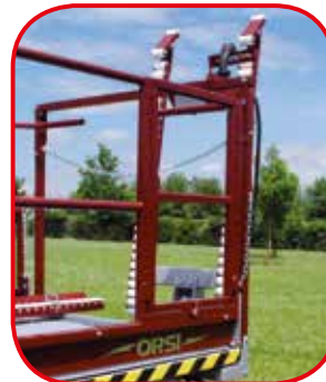
SCALETTA VERTICALE: NON INGOMBRA E PUÒ ESSERE USATA TRA I FILARI.
