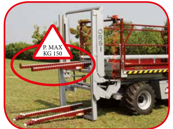
FORCHE SUPPLEMENTARI BINS ELEVATORE A COLONNA
