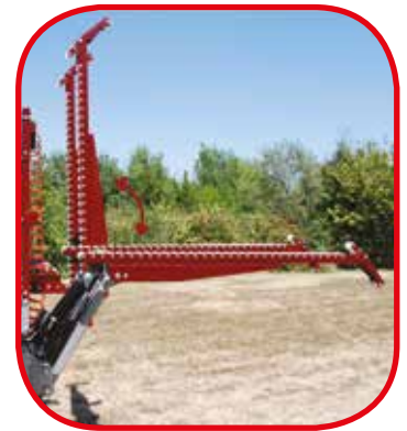
RIBALTAMENTO IDRAULICO FORCHE
