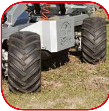
3 ANGOLI DI STERZATURA IN SIMULTANEA: LO STERZO ANTERIORE SEGUE SEMPRE PERFETTAMENTE QUELLO POSTERIORE
