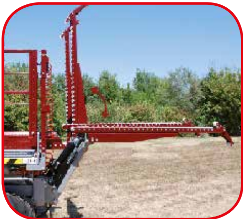
RIBALTAMENTO IDRAULICO FORCHE
