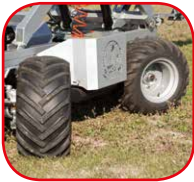
3 ANGOLI DI STERZATURA IN SIMULTANEA: LO STERZO ANTERIORE SEGUE SEMPRE PERFETTAMENTE QUELLO POSTERIORE
