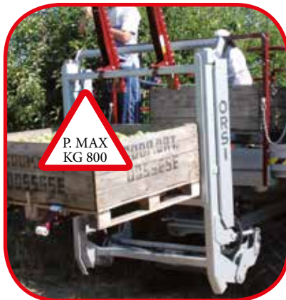
ELEVATORE POST. A COLONNA KG 800
