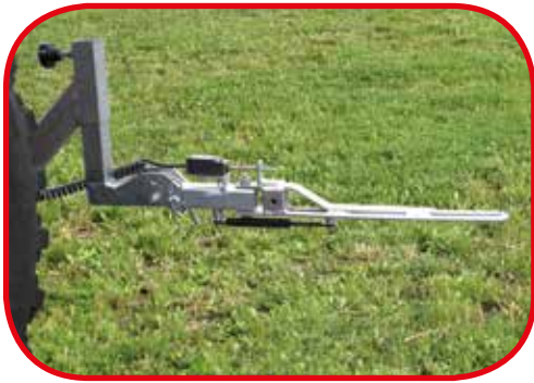
AUTOPILOT CON TASTATORE TELESCOPICO MANUALE E MEMORIZZAZIONE DELLA VELOCITÀ PREIMPOSTATA
