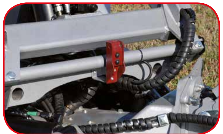
COMANDO ELEVATORE POSTERIORE DA TERRA O DA PIATTAFORMA
