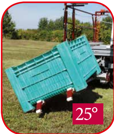
ROTAZIONE IDRAULICA SOLLEVATORE PER CARICO E SCARICO IN PENDENZA HYDRAULIC ELEVATOR'S ROTATION FOR LOADING/UNLOADING IN SLOPE HYDRAULISCHE SAULENHEBERSROTATION FÜR GENEIGTE LADEN/AUSLADEN ROTATION HYDRAULIQUE SUR ELEVATEUR POUR CHARGEMENT/DECHARGEMENT EN PENTE ROTACION IDRAULICA EN EL ELEVATOR POR CARGA/DESCARGA EN PENDENCIA
