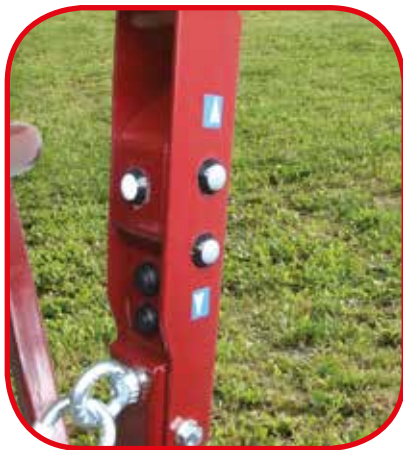
COMANDO ELEVATORE E START E STOP DALLA PIATTAFORMA
