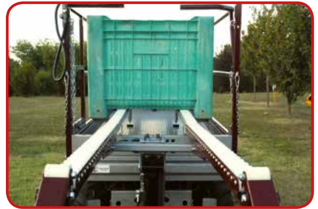
RULLIERE SOTTO PANCIA MOD. 3000 KG 42 / MOD. 5000 KG 65
