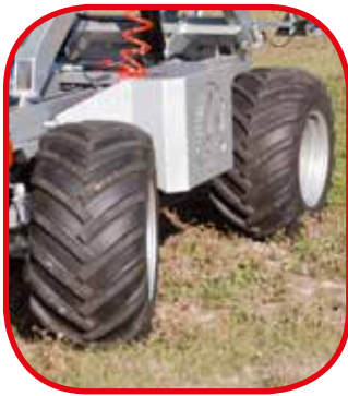
3 ANGOLI DI STERZATURA IN SIMULTANEA: LO STERZO ANTERIORE SEGUE SEMPRE PERFETTAMENTE QUELLO POSTERIORE
