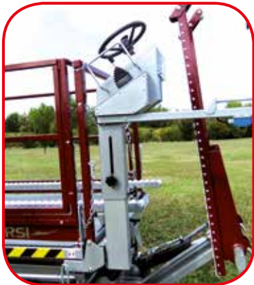
CONSOLE DI COMANDO REGOLABILE IN ALTEZZA
