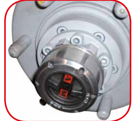
SBLOCCO RUOTE POSTERIORI PER TRAINO
