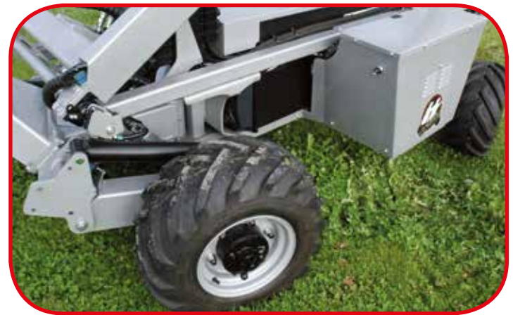
GRANDINE: 4 RUOTE MOTRICI, 4 RUOTE STERZANTI GRANDINE: 4 WHEELS DRIVE 4 HEELS STEERING GRANDINE: 4 ANTRIEBSRÄDER 4 LENKRÄDER GRANDINE: 4 ROUES MOTRICES 4 ROUES DIRECTRICES GRANDINE: 4 RUEDAS MOTRICES 4 RUEDAS DIRECCIONAL
