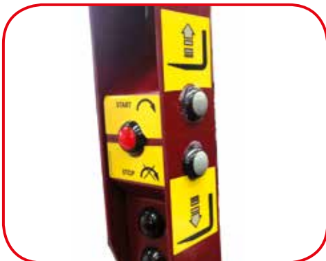
COMANDO ELEVATORE E STOP & GO DALLA PIATTAFORMA
